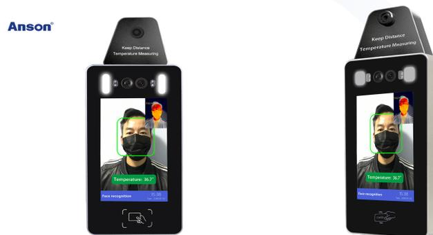
El dispositivo de medición de temperatura y reconocimiento facial es un tipo de dispositivo de control de acceso y asistencia de tiempo integrado con la función de detección de fiebre. Adopta un algoritmo rápido y preciso de medición de temperatura y alarma de temperatura dinámica, reconocible incluso con máscara.
