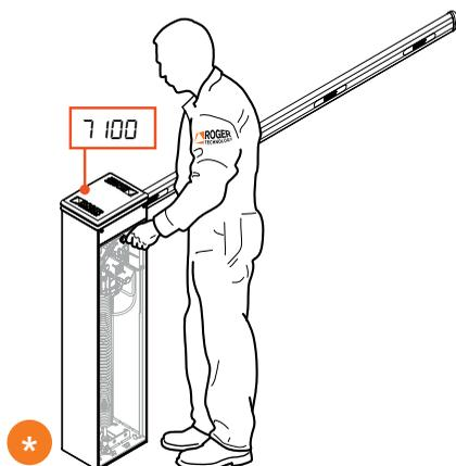
PARAMETRIZZAZIONE DELLA POSIZIONE DELL' INSTALLAZIONE DELLA BARRIERA CON POSIZIONAMENTO DELL' ARMADIO A DESTRA E VARCO PASSAGGIO DELL' ASTA A SINISTRA
